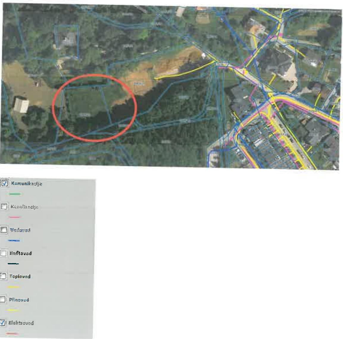
Slika 6: Prikaz poteka vodov in objektov vodovodnega in kanalizacijskega omrežja in ravnanje z odpadki,
