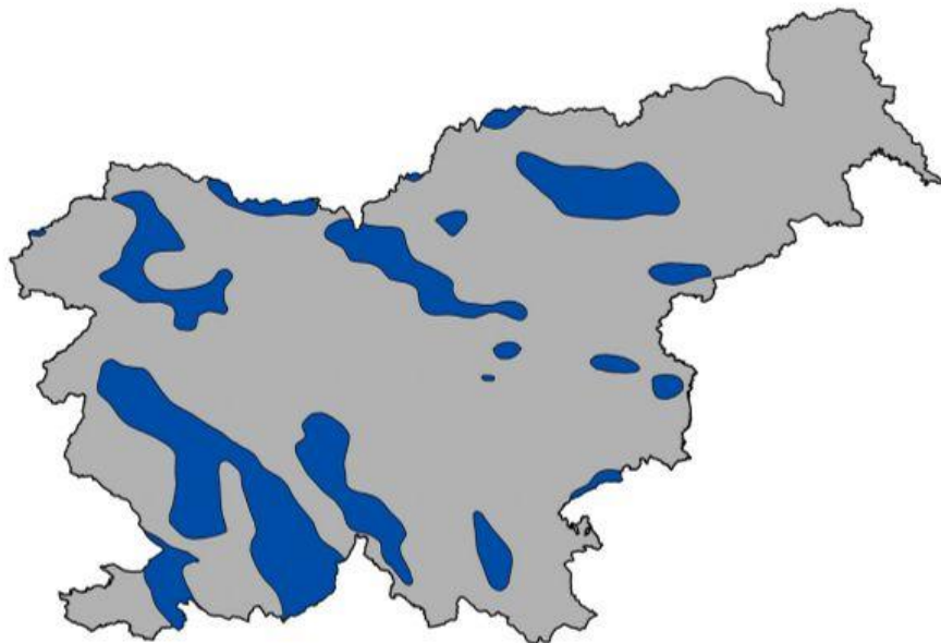
Slika 27: Vetrovno primerna območja – območja s povprečno hitrostjo vetra več kot 4,5 m/s 50 m nad tlemi v obdobju 1994-2000 iz modela Aladin DADA. Vir: Celovit pregled potencialno ustreznih območjih za izkoriščanje vetrne energije - strokovna podlaga za NEP 2010-2030, Aquarius d. o. o., februar 2011.
